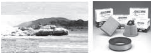
شکل ۷. الف) فیلتر نانو لیفی تصفیه هوا و ب) تانک جنگی M1A1 استفاده کننده از فیلتر هوای نانو لیفی
