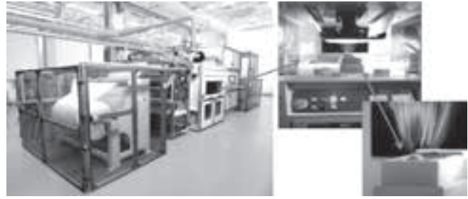
شکل ۵. دستگاه تولید لایه نانو لیفی شرکت المارکو [۶]
